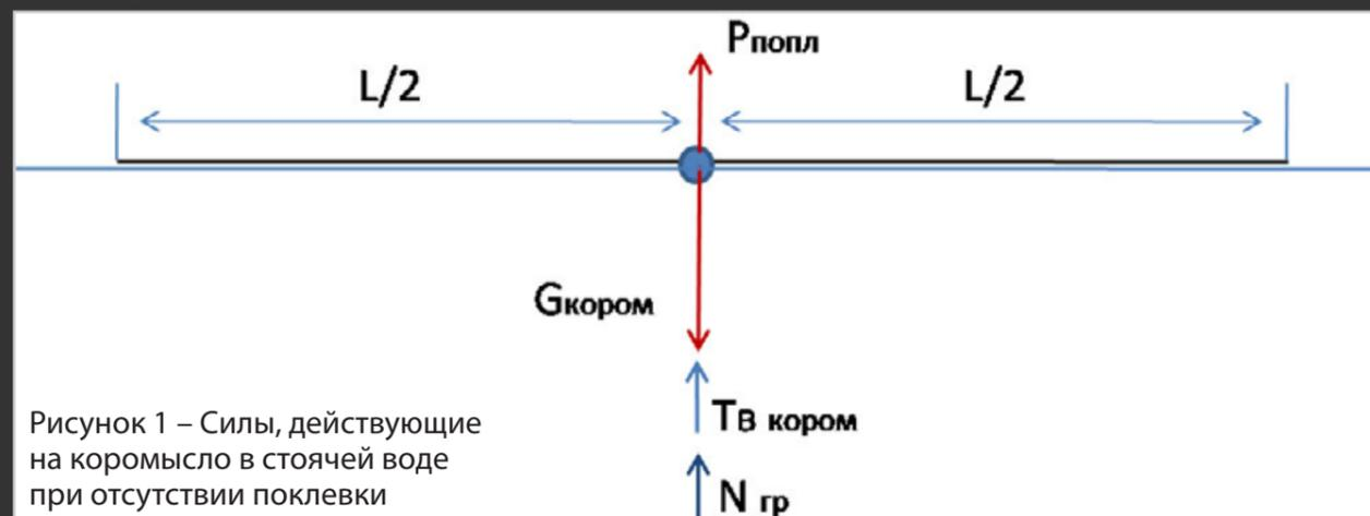
Рисунок 1 – Силы, действующие на коромысло в стоячей воде при отсутствии поклевки
