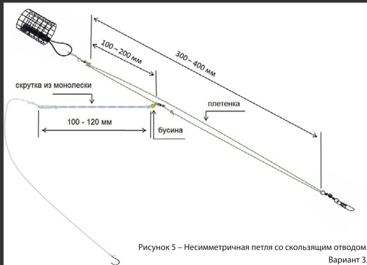
Рисунок 5 – Несимметричная петля со скользящим отводом. Вариант 3.
