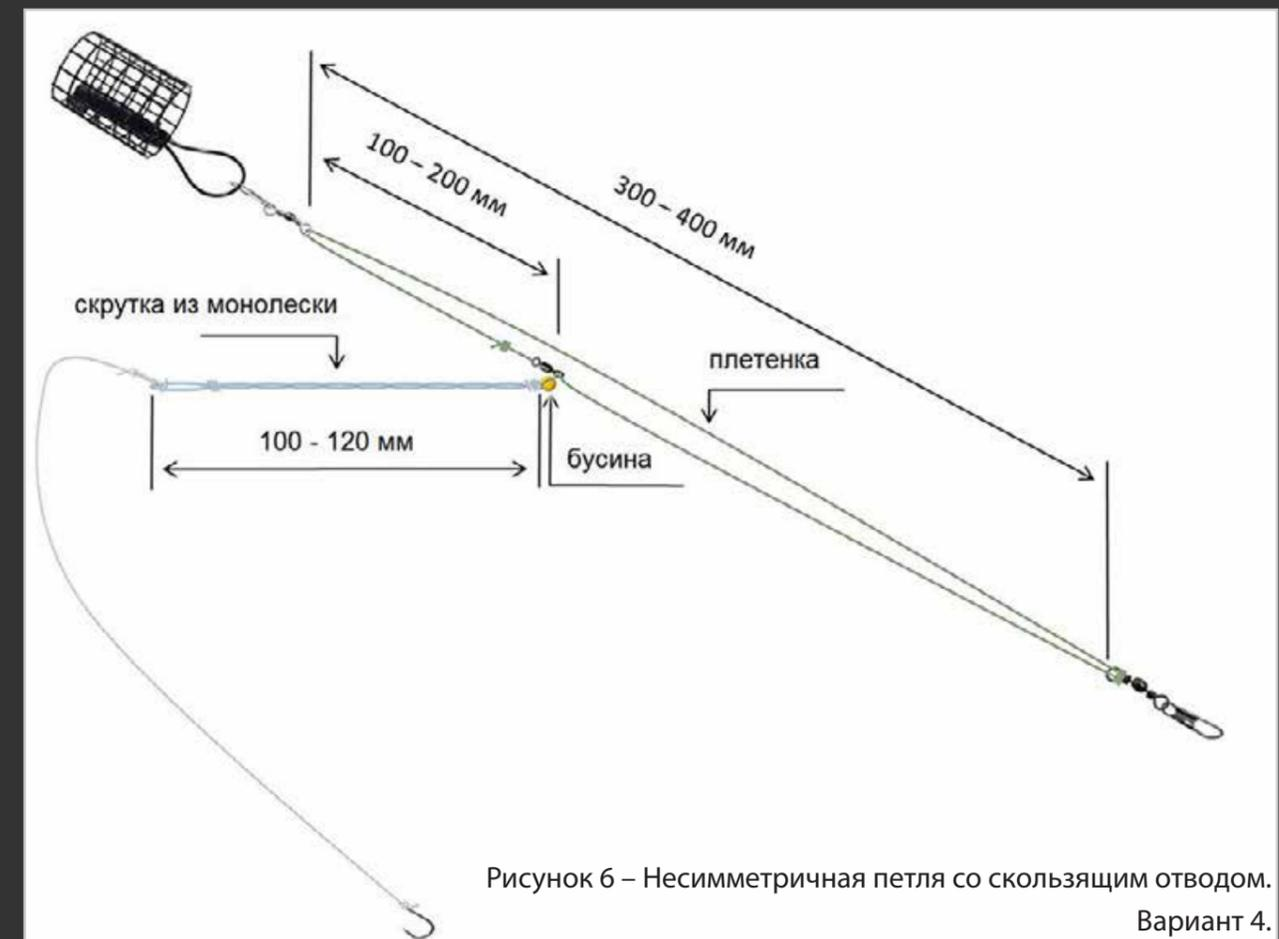
Рисунок 6 – Несимметричная петля со скользящим отводом. Вариант 4.
