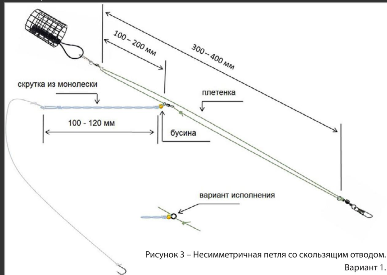
Рисунок 3 – Несимметричная петля со скользящим отводом. Вариант 1.
