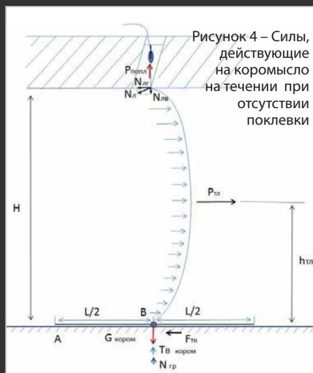
Рисунок 4 – Силы, действующие на коромысло на течении при отсутствии поклевки
