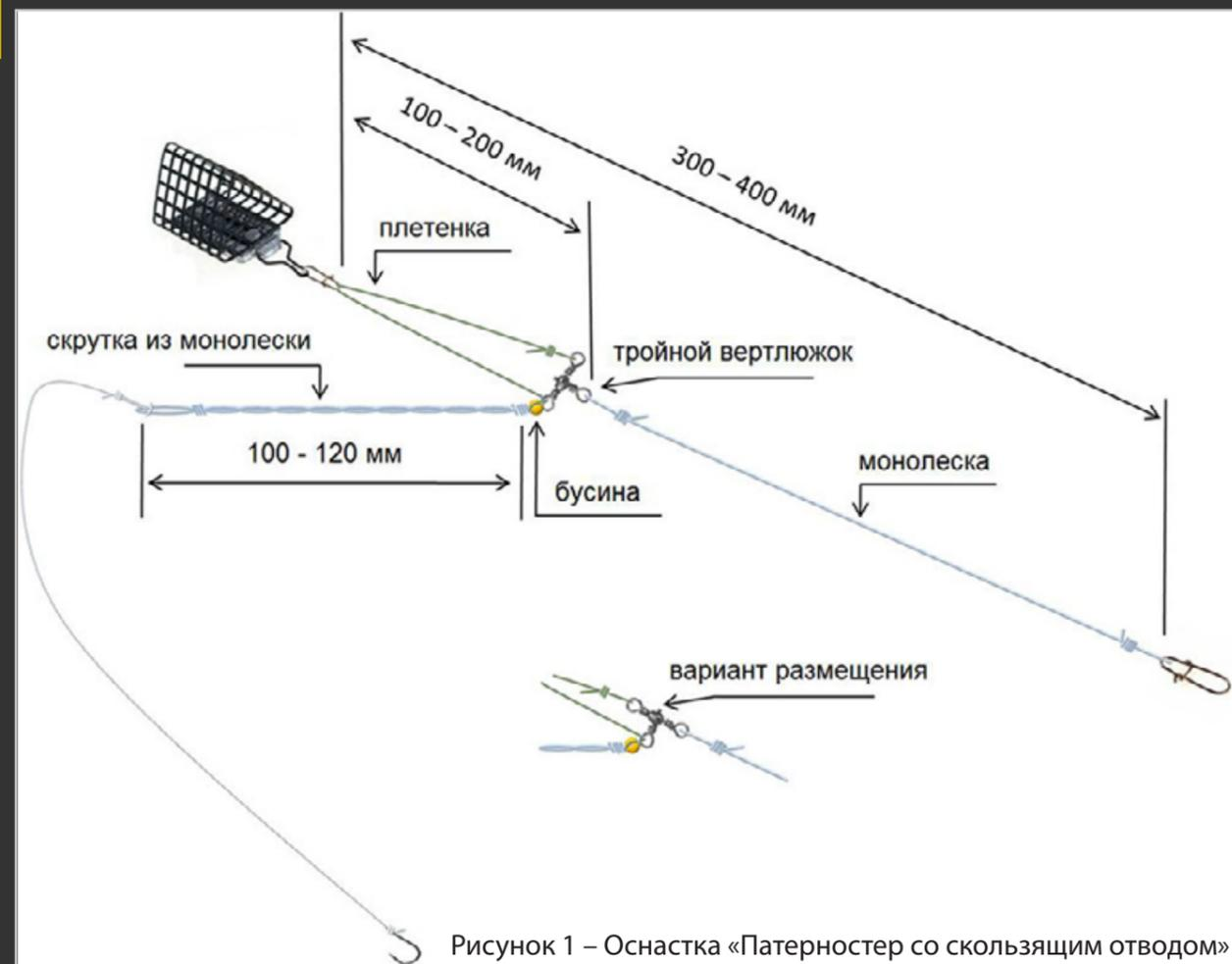
Рисунок 1 – Оснастка «Патерностер со скользящим отводом»
