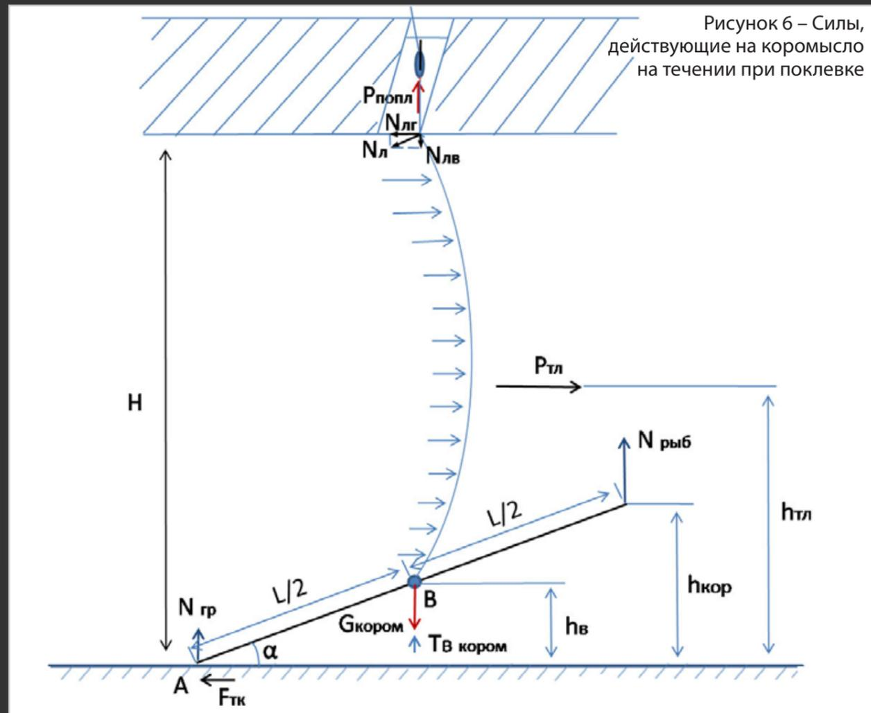
Рисунок 6 – Силы, действующие на коромысло на течении при поклевке
